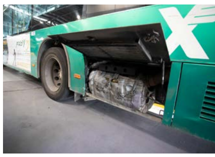
מסנן חלקיקים המותקן באוטובוס שמפחית כ-97% מפליטת החלקיקים מרכבי דיזל ישנים
